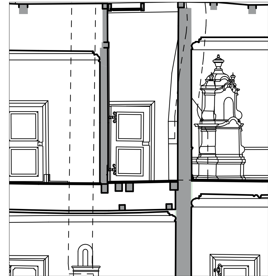
Abb. 8 Die Böden und Decken im Prälatenstock sind zweilagig gebaut. In fast allen Räumen liegen zwei Balkenlagen übereinander. Der Abstand beträgt bis zu 80 Zentimeter. Eine solche Deckenkonstruktion ist auch von anderen hochwertigen Barockbauten bekannt.
